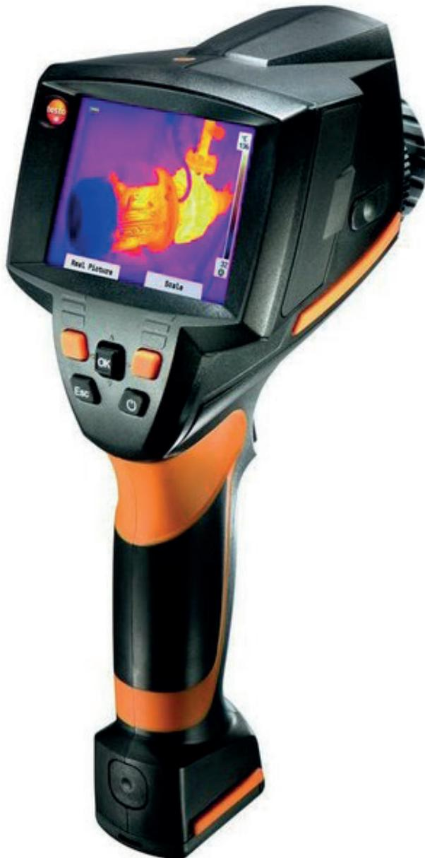
La THCAM è una termocamera ad infrarossi che serve per identificare le persone con una temperatura corporea più elevata e consente di effettuare i controlli su persone potenzialmente malate in luoghi con elevati flussi di persone.
